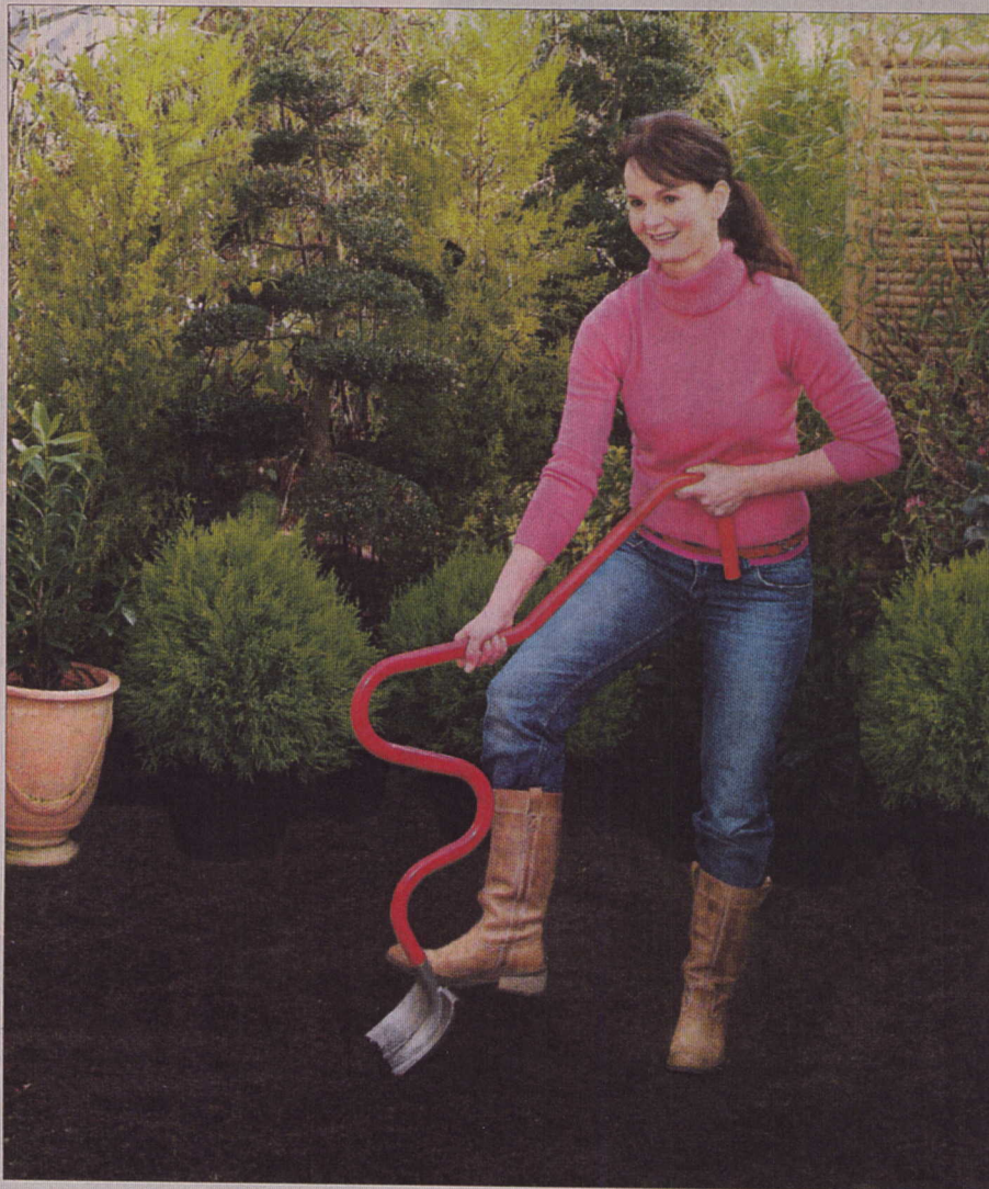
„Besser ein gebogener Griff als ein gebogener Rücken“ – so das augenfällige Prinzip dieses Schaufel-Spatens (großes Bild) und Besens (kl. Bild). Bei der Gartenarbeit belasten insbesondere die Hebe-Dreh-Bewegungen Rückenwirbel, Bandscheiben und Gelenke. Fotos ergobase
